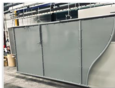
Remise en peinture après galvanisation « au trempé »
